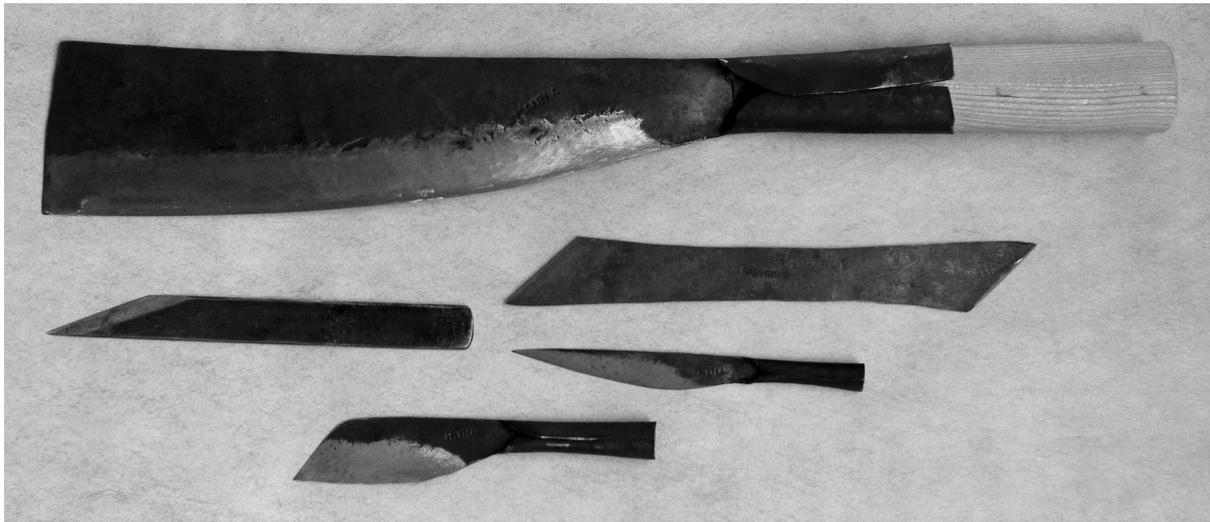
*Abb. 56 Verschiedene vietnamesische Messer zur Bambus-Beatbeitung. Das große ist das Hauptwerkzeug, die kleinern Kligen dienen zu Feinarbeiten.*
