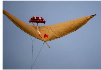
Abb. 9 Ein Drachen mit zu schwachen Leisten hatte einen übertriebenen Flächenwinkel
